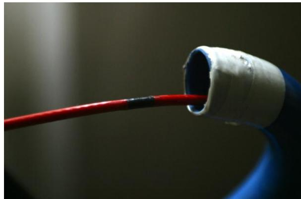
**En aucun cas**, la marque ne doit être à l'intérieur du tuba. Si cela se produit, il faut couper un bout du tuba. **L'embout fait parti du tuba**
